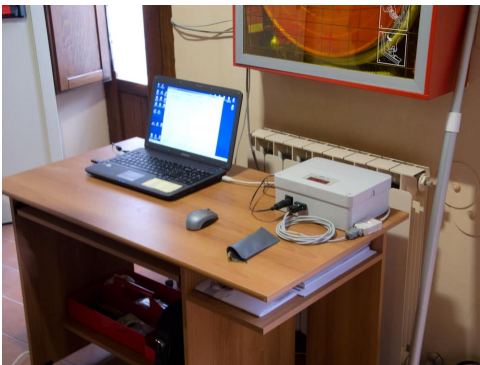
Sistema di acquisizione dei dati (a sinistra) e grafico forza/allungamento in un test a caduta (a destra)
