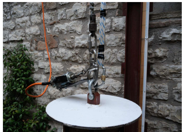
Particolari della torre di caduta: cella di carico, misuratore laser (a sinistra) e sistema di sgancio del peso (sopra)
