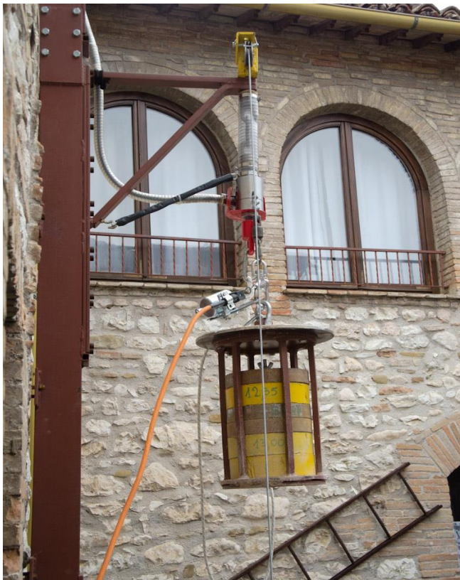
Particolari della torre di caduta: cella di carico, misuratore laser (a sinistra) e sistema di sgancio del peso (sopra)
